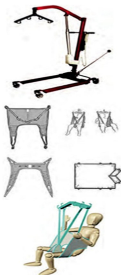
Рис. 39. Использование подъемника с подвесом
